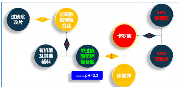
图1 过硫酸氢钾复合盐的简略生产工艺图
